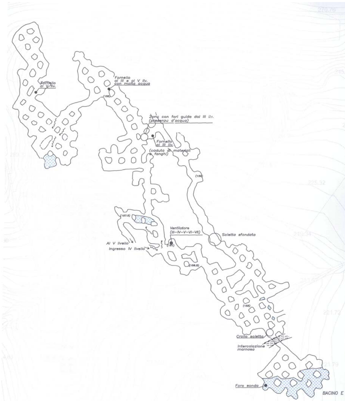
Figura 32: planimetria rappresentativa delle modalità di coltivazione dei livelli di cava
