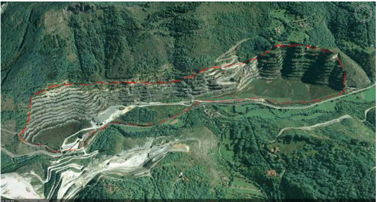
Figura 23: modellazione in 3D di un'area di cava per la stima delle superfici e dei volumi utili
